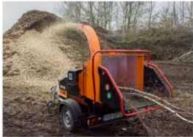
Rampe de chargement et barre de sécurité.
