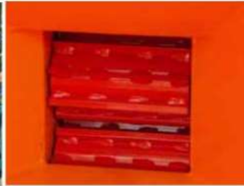
Rouleaux acheminant le matériau vers l'ensemble des couteaux à déchiqueter.
