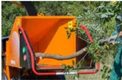
Les branches sont ramassées automatiquement au moyen de rouleaux d'alimentation à entraînement hydraulique.
