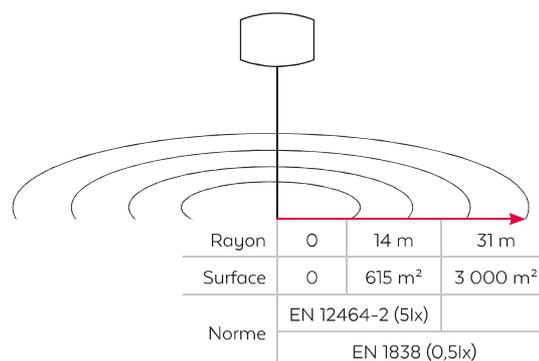
Comprendre le schéma : dans un rayon d'action de 31 m, soit une surface de 3 000 m<sup>2</sup>, nous garantissons un éclairage conforme à la norme EN1838.
