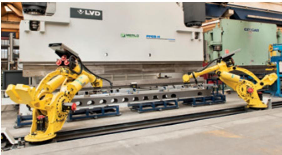
Nouveau centre automatisé à double robotisation de haute précision
