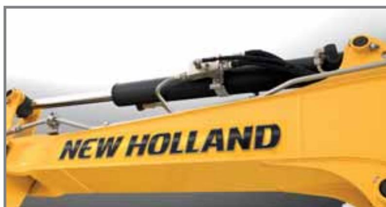
Clapets de sécurité inclus dans l'option de manutention sécurisée
