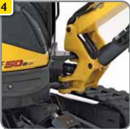
Articulation de rotation de la flèche moulée + flexibles protégés = durabilité
