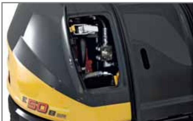
Accès rapide et pratique au sélecteur du circuit auxiliaire : unidirectionnel ou bidirectionnel
